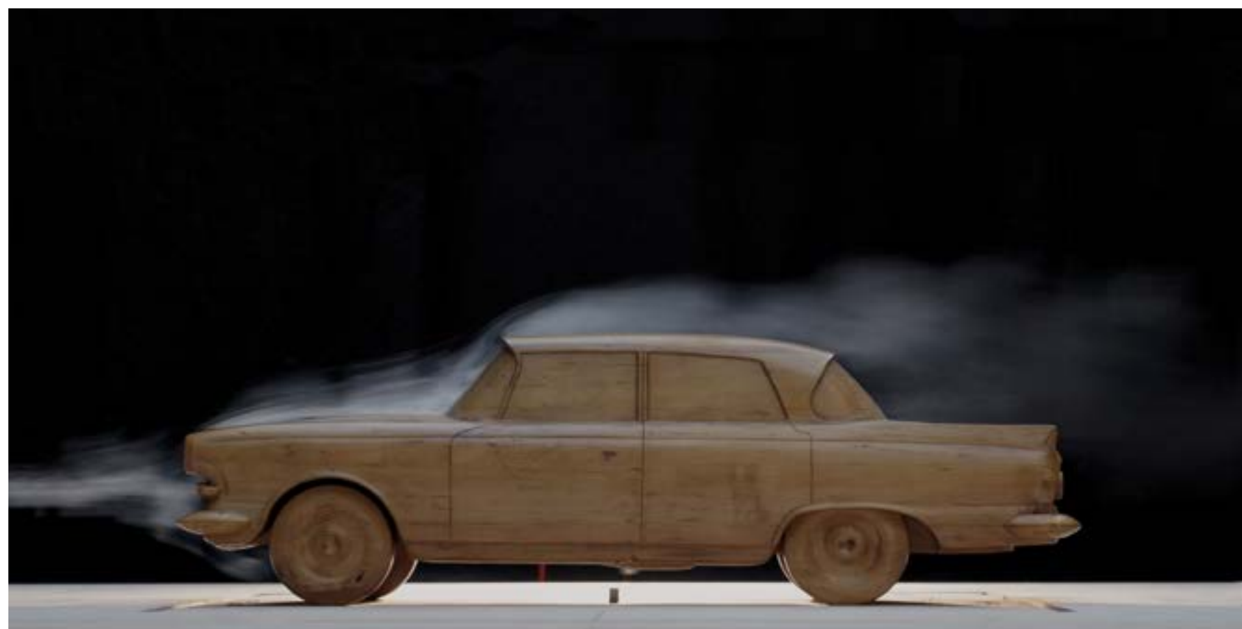
Borgward P100-1:10-Modell im Focke-Windkanal Bremen . Foto Peter Kurze
