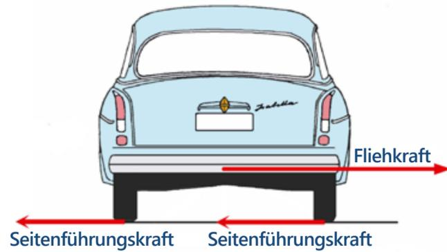
Fliehkraft zieht das Auto aus der Kurve heraus. Seitenführungskräfte stehen dem entgegen.
