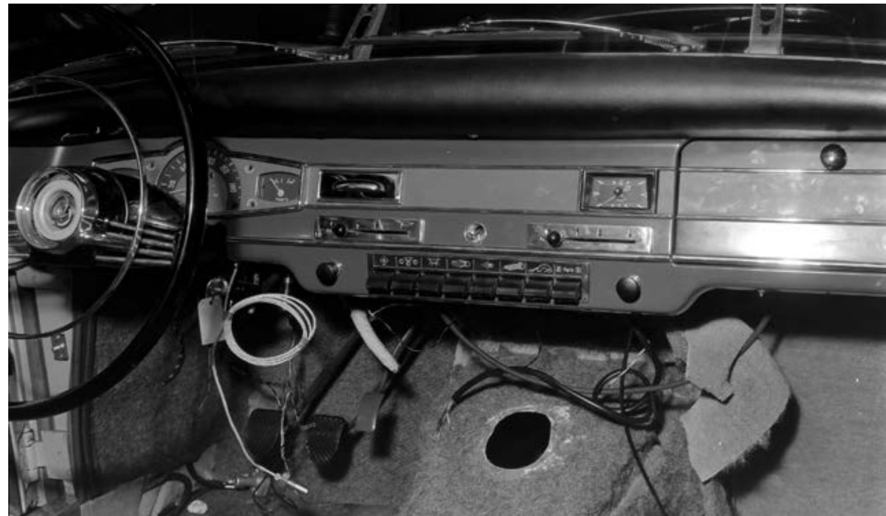
Vorbereitung des Ausstellungs-Coupés für die IAA 1961 in der Versuchsabteilung. Änderungen gegenüber dem Vormodell: 100-PS-Motor vom P100, dunkles Armaturenbrett mit VDO-Uhr von der Mercedes S-Klasse, geänderte Instrumente und Knüppelschaltung. Das Loch im Gelenkwellen-Tunnel war notwendig für den Schalthebel des 4-Gang-Getriebes.
